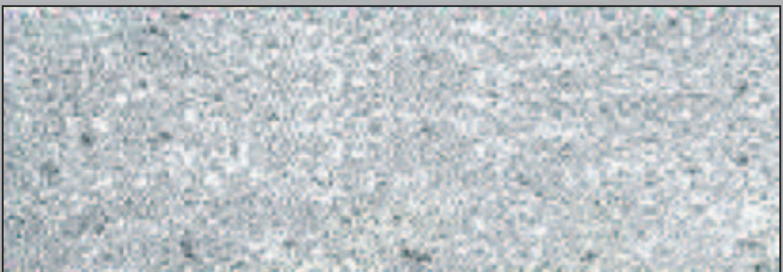
Fotografia al microscopio di granito trattato con Multigranit: completamente assente qualsiasi alone dei liquidi utilizzati nei test di prova / Microscope picture of granite treated with Multigranit: absolutely no marks of the liquid substances used for the test
