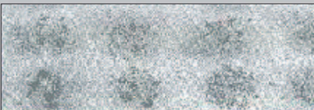
Fotografia al microscopio di granito non trattato: sono ben visibili gli aloni dei liquidi utilizzati nei test di prova / Microscope picture of not treated granite: visible marks of the liquid used for the test
